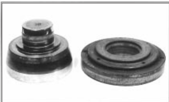
Matrices para laminación axial cerrada.
