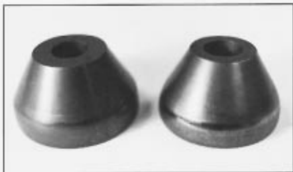
Utillajes realizados en VANADIS 23 con recubrimiento PVD para conformado en frío de tubos.
